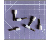
Rechts: Crimpzange und Aderendhülsen
